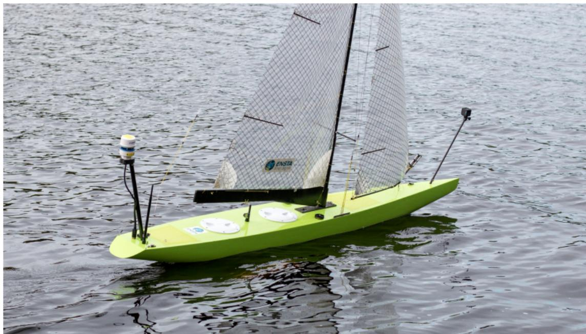
*Brave*, voilier autonome équipé de caméras pour la détection d'obstacles
