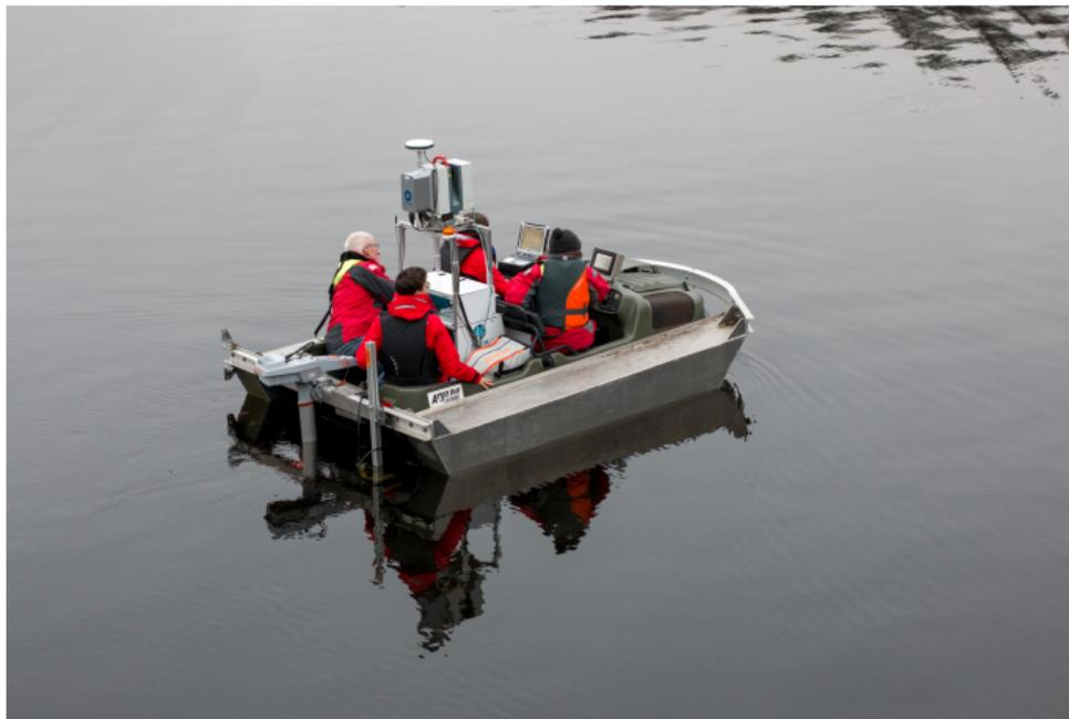
Véhicule amphibie *Argo* équipé de laser/sonar/IMU/GPS
