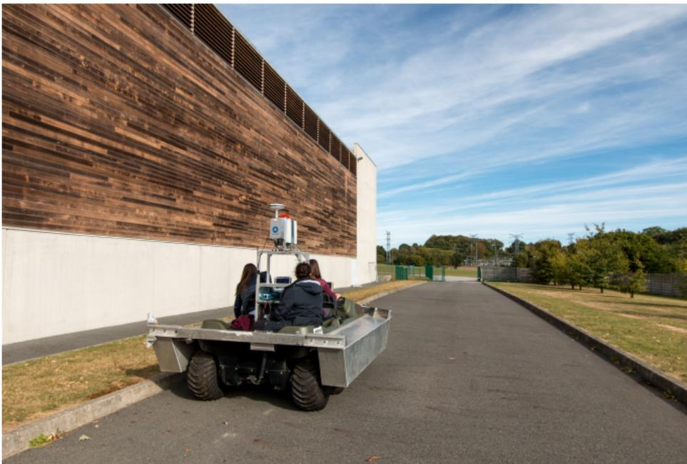
Véhicule amphibie *Argo* équipé de laser/sonar/IMU/GPS
