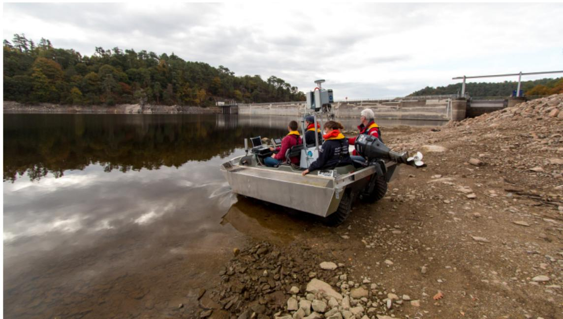
Véhicule amphibie *Argo* équipé de laser/sonar/IMU/GPS
