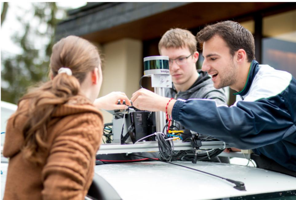
Voiture de l'école équipée d'une centrale et d'un LIDAR
